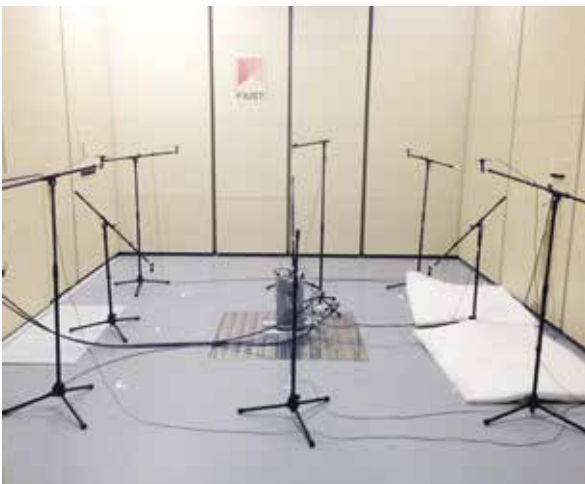
Akustikmessung von Hydraulikaggregaten – zertifiziert nach DIN EN ISO 3745
