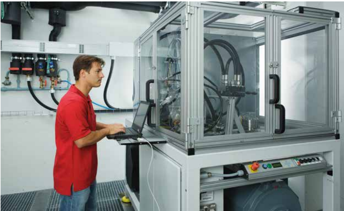
Funktionsprüfstand mit 300 kW elektronischer Antriebsleistung
