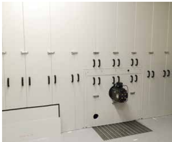
Akustikmessung von Hydraulikpumpen
