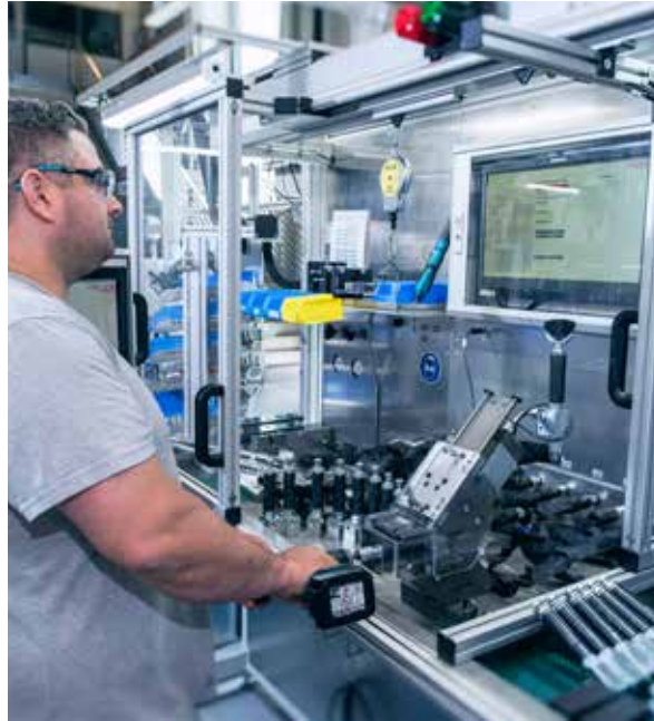
Hydraulische End- und Funktionsprüfung eines Ventils
