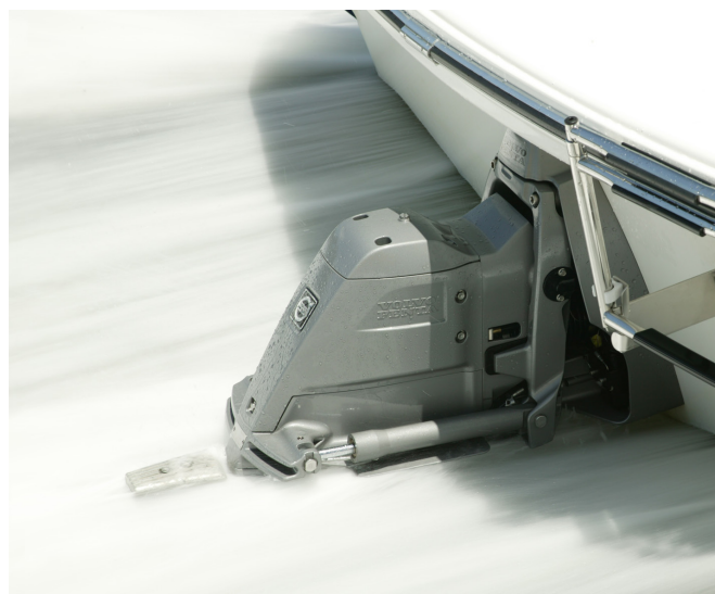
Z-Antrieb mit dezentralem, hydraulischen Trim-/Tilt-System
