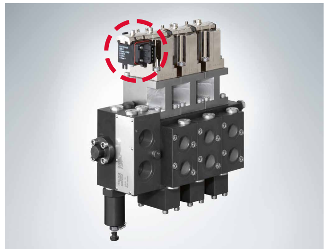
Das Wegeventil mit direkt montiertem CAN-Kopf als Betätigung wird nur noch über einen Stecker an den CAN-Bus angeschlossen. (Bild: HAWE Hydraulik)
